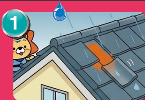
1 屋根 (屋根材のズレ・ひび割れ)
