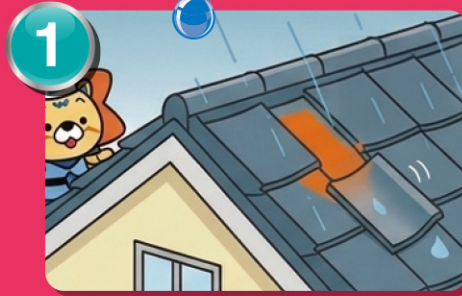
1 屋根 (屋根材のズレ・ひび割れ)
